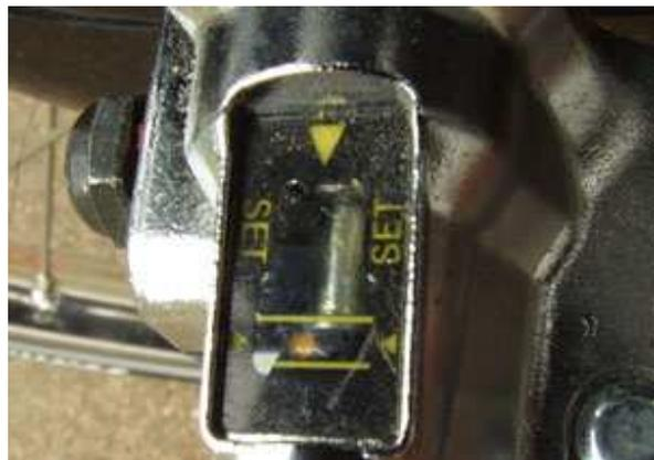
5- une fois la ligne jaune alignée serrer le contre-écrou pour figer la vis moletée
