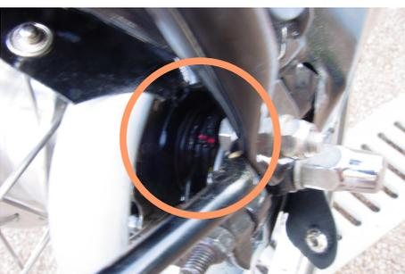
Le réglage du câble se fait en tournant le bouton moleté montré sur la photo ci-dessous : on tire la pièce plastique vers la gaine afin qu'elle prenne l'écrou de réglage et on tourne.
