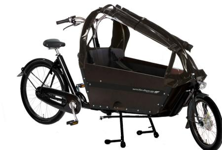
**Système** : La tente tient grâce à son armature et s'accroche à la caisse grâce à 2 boutons pression à l'avant et 2 élastiques à l'arrière.
