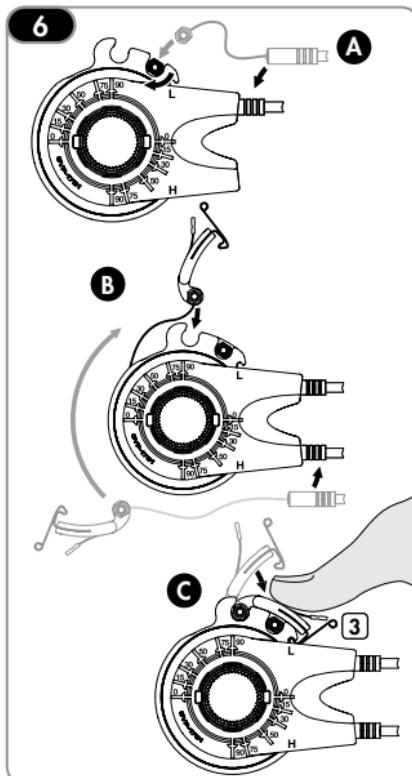
**6** Monteer het bevestigingsmateriaal voor de schakelkabel door de stappen **A**, **B** en **C** te doorlopen.
