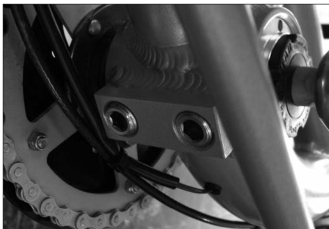
Fig.7; Desserrez la vis de l'excentrique
