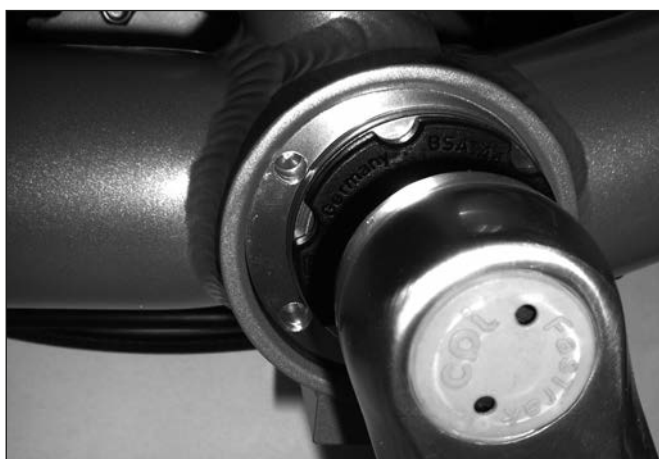
Fig.7.1; Tournez l'excentrique pour tendre la chaîne
