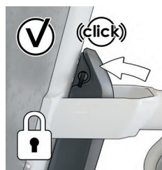
Image 17 : Batterie correctement installée
